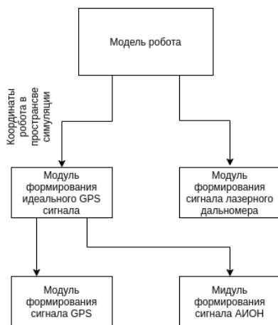
Рис. 3. Схема формирования сигналов датчиков
