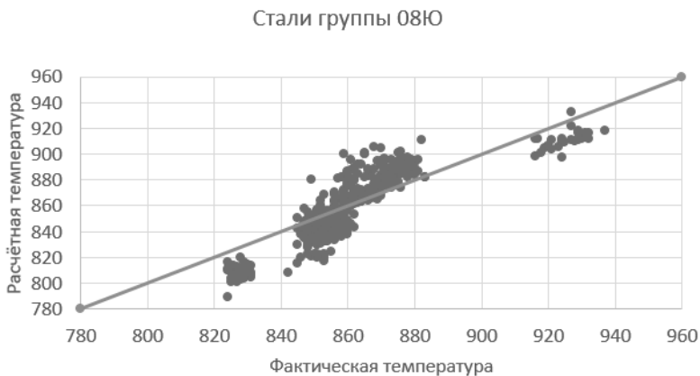
Рис. 6. Сравнение фактических и расчетных температур для стали 08ю
