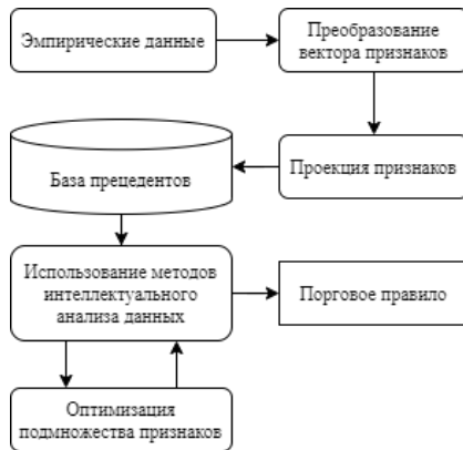
Рис. 1. Схема анализа данных в задаче диагностики электродвигателя
